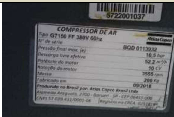
COMPRESSOR TIPO PARAFUSO 10HP VAZAO 45 PCM - 380V - IP55
