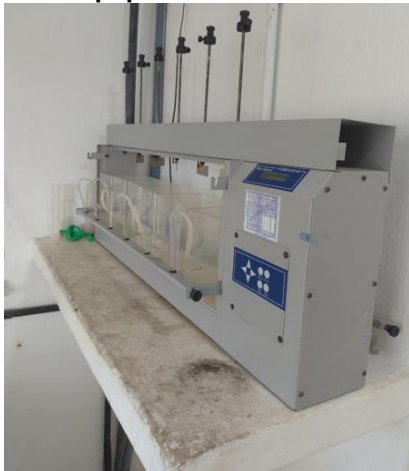
Figura 18 - Equipamento de Jar test
